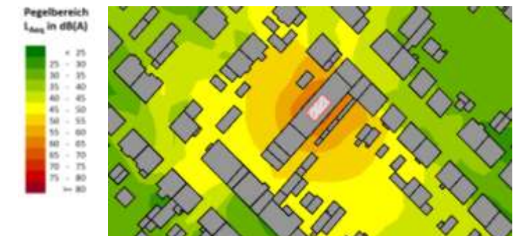
Bild 1b: Nach raumakustischer Konditionierung des Kälteanlagencontainers
